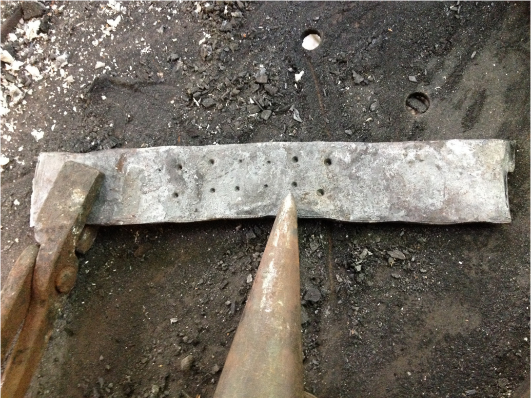
Abb. 1: Zieheisen (30,5 x 5,5 x max. 0,6 cm) mit 11 Ziehholen (von 2,5-5,0 mm) und Werkzeug (Zange, Dorn). – Iron drawplate (30,5 x 5,5 x max. 0,6 cm) with 11 holes (2,5-5,0 mm) and tools (drawtong, prickler).
