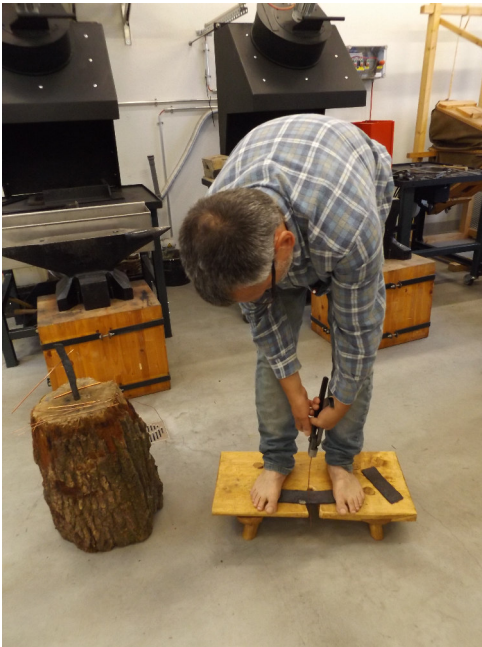
Abb. 3: Drahtziehen mit dem Ziehschemel. – Wire drawing with foot stol.
