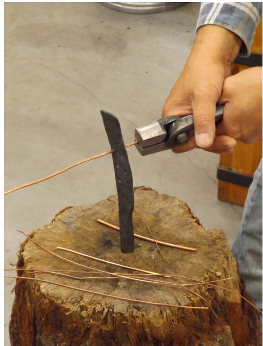
Abb. 6: Verbogenes Zieheisen; Kupferdrähte von 3,5-1,0 mm gezogen. – Bent iron drawplate; Copper wires drawn from 3,5-1,0mm.
