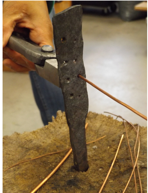
Abb. 5: Drahtziehen am eingelassenen Zieheisen. – Wire drawing with fixed iron drawplate.
