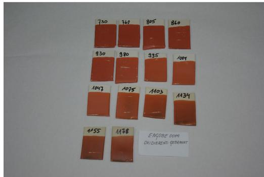
Abb. 11: Die Brenntafeln aus den Labortests zeigen exemplarisch die Engobentauglichkeit der untersuchten Tone. Links: Ton 0003 (rot; Geishecker Hof), rechts: Ton 0004 (Glanztön; Eichenweg). – The firing plaques from the laboratory tests exhibit the capability of the slip-glazes created from the different clays. Left: Clay 0003 (red, Geishecker Hof), right: Clay 0004 (luster clay, Eichenweg).
