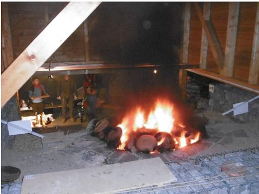
Abb. 2: Flammenauschlag (Reduktionsflamme) während einer reduzierenden Phase. Anhand solcher Merkmale informieren sich Töpfer auch ohne großen apparativen Aufwand über die unterschiedlichen Brenn Atmosphären in ihrem Ofen. – Flames during a reduction phase. According to such characteristics, it was possible for the potter to gain knowledge about the atmospheric conditions inside the kiln without the use of complicated modern equipment.
