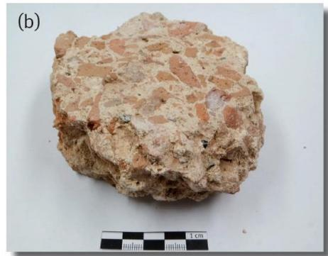
Abb. 1: Handstücke aus Xanten (1a) und Schwarzenacker (1b). Auffällig ist das sehr reine Weiß des Bindemittels aus Xanten. Das Bindemittel der Probe aus Schwarzenacker weist eine mehr ockerfarbene Färbung auf. – Samples from Xanten (1a) and Schwarzenacker (1b). Striking is the very pure white of the binder from Xanten. The binder of the sample from Schwarzenacker has a more ocher coloring.
