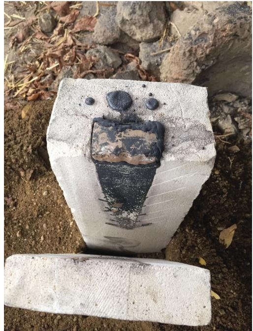
Abb. 9: Frisch gegossener Tüllenpickel in der Sandsteinform, mit Kern und Abdeckplatte. – Newly casted pick in the sandstone mould, with the core and the cover.
