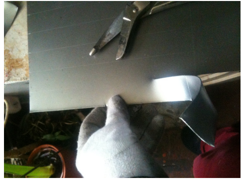
Abb. 3: Das Ausschneiden der Panzerschuppen. – The cutting-out of the scales.
