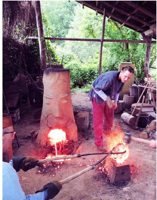
Abb. 1: Experimentelle Versuche zur Verhüttung von Eisenerz im Schachtofen. Die aus Eisenerz bestehende Luppe mit etwa 5 kg wurde gerade aus dem Ofen genommen und wird nun bei etwa 1.245°C verschweißt, um Verunreinigungen auszuscheiden. – Practical experiments concerning the smelting of iron in a chimney furnace. The iron lump existing mostly of thin foils gets welded at a temperature of about 1.245°C to expel contaminations.
