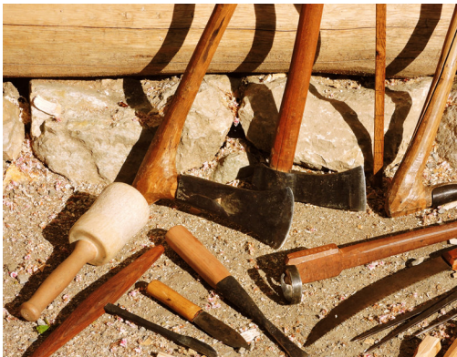
Abb. 9: Unsere eisenzeitlichen Werkzeuge: Tüllenbeil, Schaftlochaxt, Lappen-dechsel, Maßstock, Klopffholz, Löffelbohrer, Schnitzmesser, Tüllenstembichel, Ziehmesser, Zugsäge, Zirkel und Reiß-ahle sowie Holznägel. – Our Iron Age tools: Socketed hatchet, shaft hole axe, adze on a kneehafting, measure stick, knocking wood, spoon drill, carving knife, socketed chisel, drawing knife, drawing saw, compasses, awl and wooden nails.
