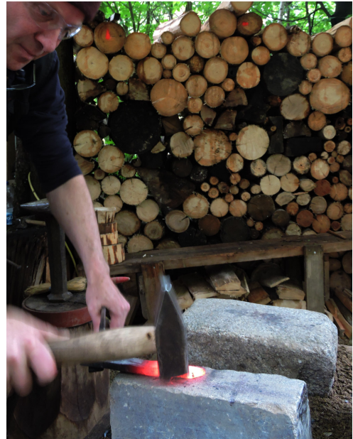
Abb. 3: Im Rahmen unserer praktischen Versuche zur eisenzeitlichen Schmiedetechnologie testeten wir verschiedene Gesteinsarten auf ihre Funktionalität als Ambosssteine. – In the course of our practical experiments on Iron Age forging we tested different sorts of stone concerning their functionality as anvils.
