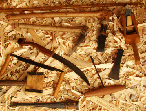
Abb. 3: Einige unserer eisenzeitlichen Werkzeuge: Meßstock, Tüllendechsel, Lappenbeil, Ärmchenbeilhobel mit Ersatzklinge, Zugsäge, Ziehmesser, Holzhammer, Löffelbohrer und Tüllenmeißel. – Some of our Iron Age tools: measure stick, socketed adze, hatched plane with extra blade, drawing knife, wooden hammer, spoon drill and socketed chisel.
