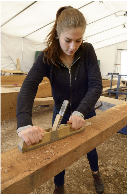
Abb. 2: Erprobung der Rekonstruktion eines in der CUT gefundenen Hobels. – Practical trial of a reconstructed plane found in the CUT.
