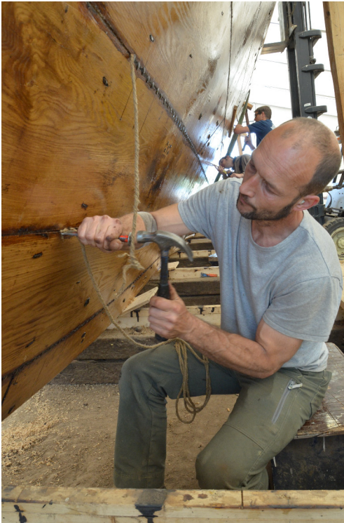
Abb. 5: Einbringung des Kalfats, Kalfatnägeln. – Caulking material and nails.
