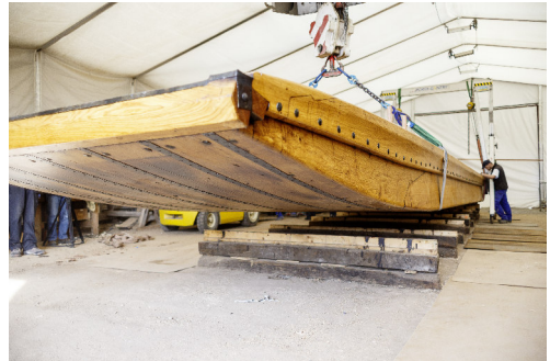
Abb. 4: Eisenbänder zum Schutz der Kalfaterung an den Kaffen. – Iron bands protecting the caulking of the swimhead.
