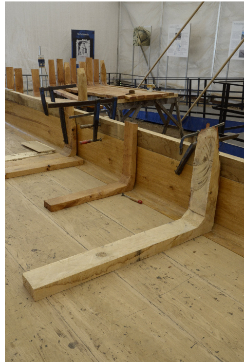
Abb. 3: Einpassung von Spanten in den Schiffsrumpf der Nehalennia. – Adjusting frames in the hull of the Nehalennia.
