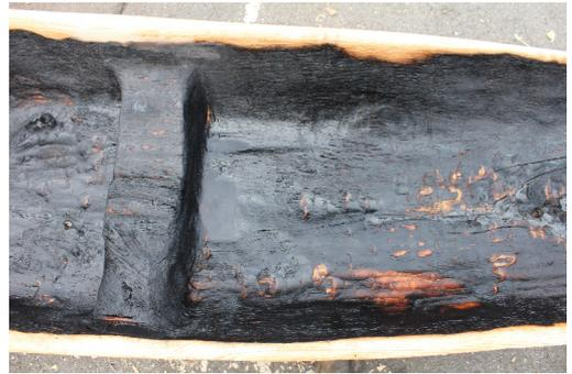
Abb. 6: Verrundete Kanten an einer der Schwellen nach dem ersten Brand. – The edges have lost their sharpness after the 1<sup>st</sup> burning.
