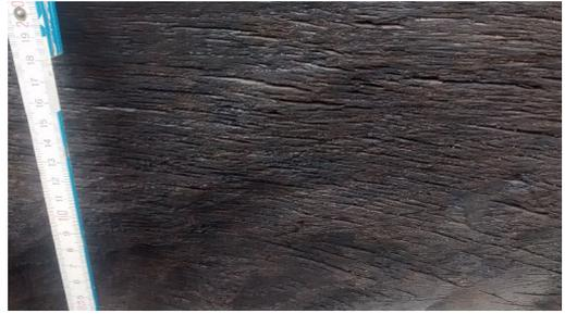
Abb. 8: Rissige Oberfläche (Fissuren) am Nachbau. – Fissured surface on the replica.
