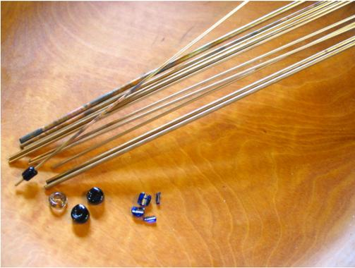
Abb. 6: Zylindrische Perlendorne aus Bronze, genutzt ohne jegliches Trennmittel. Die aufgesplante Perle zeigt die typische metallische Verfärbung. – Bronze mandrels, used without bead separating substance. The bisected bead shows the characteristic metallic shine.
