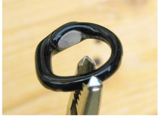
Abb. 2: Anhaftendes Trennmittel im Loch einer Wickelperle. – Cemented bead separator sticking inside a wound bead.
