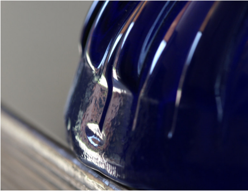
Abb. 13: Werkzeugspuren im äußeren Randbereich einer noch nicht überarbeiteten Rippenschale von Mark Taylor und David Hill. – The outer rim area of a ribbed bowl blank made by Mark Taylor and David Hill displays tool marks.
