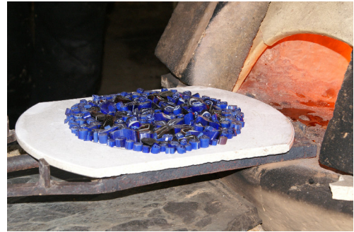
Abb. 5: Mosaikglas-Chips für eine Rippenschale auf dem Schieber. – Mosaic glass florets assembled for a ribbed bowl are placed onto a pusher/oven peel.
