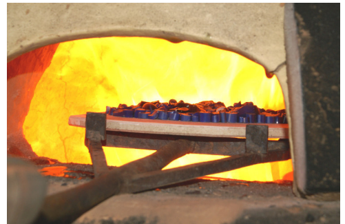
Abb. 6: Aufheizen der Mosaikglas-Chips im Glasofen. – Heating up the mosaic glass florets inside the glass furnace.
