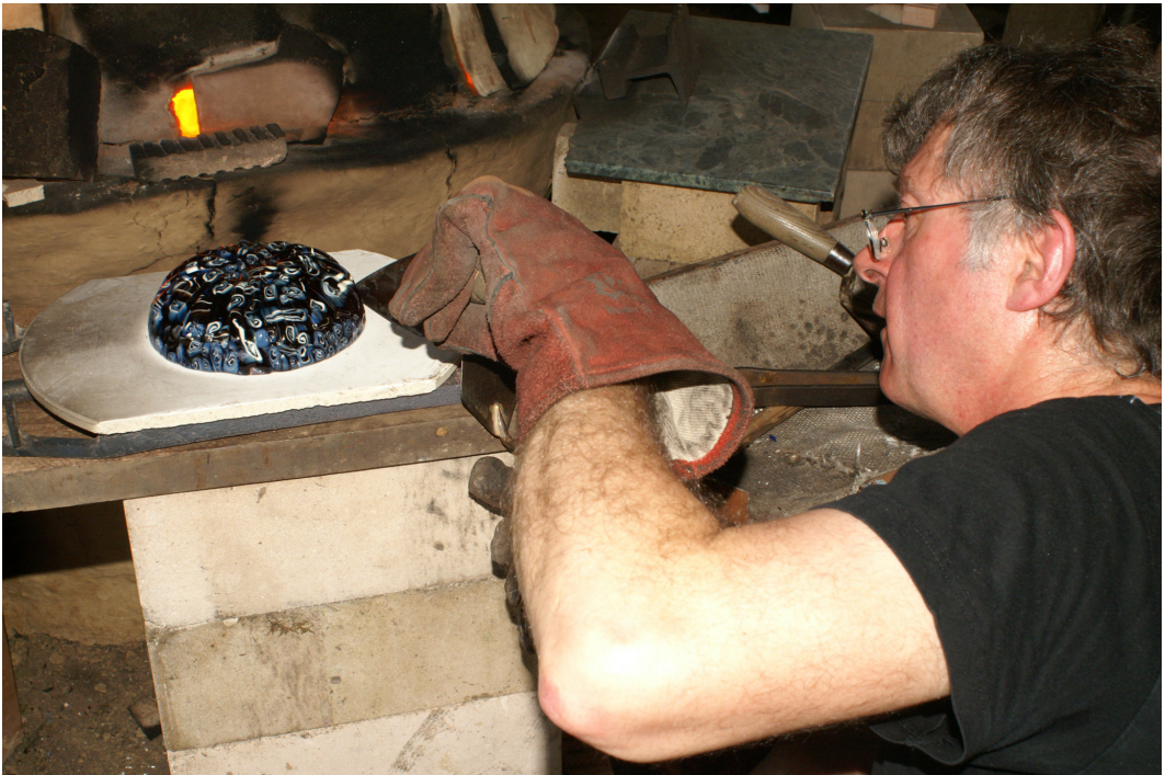
Abb. 11: Letzte Korrekturen von Mark Taylor am Rand des Rippenschalen-Rohlings, bevor dieser in den Kühllofen gelegt wird. – Last corrections of the rim of the ribbed bowl blank are carried out by Mark Taylor prior to placing it into the Lehr (cooling oven).
