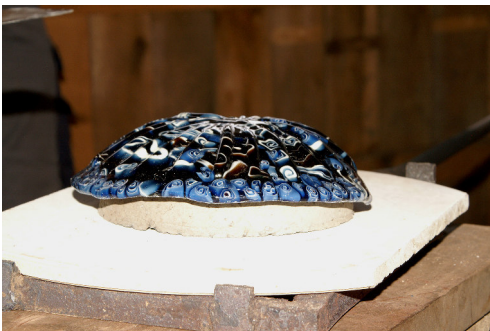
Abb. 9: oben: Auflegen des gerippten Glasfladens auf die vorgeheizte Form; unten: Absenken über die Form. – Top: Placing the ribbed disk onto the preheated mould; bottom: Slumping over the hemispherical mould.
