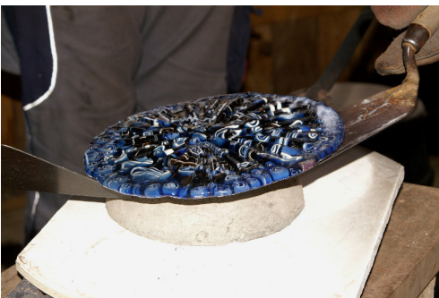
Abb. 8: Absetzen/Abflachen des Randes. – Flattening the rim area.
