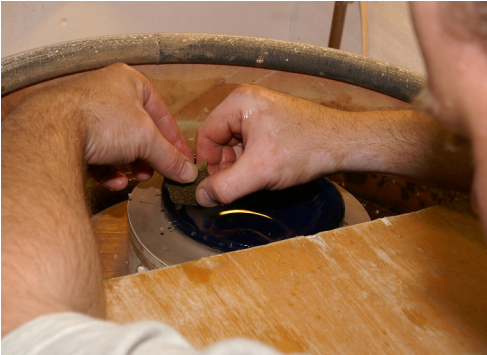
Abb. 14: Schleifen des Innenbereichs einer Rippenschale auf einer Töpferscheibe. Das Werkstück ist hierfür ungefähr zur Hälfte in Lehm eingebettet. – Grinding the inside of a ribbed bowl on a potter's wheel. Therefore the bowl is half-way embedded in loam.
