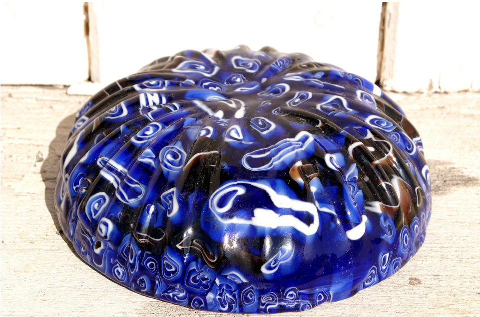
Abb. 12: oben: Der Rippenschalen-Rohling nach Entnahme aus dem Kühllofen. Die Reste des Formmaterials müssen noch entfernt und danach der komplette Innen- sowie der äußere Randbereich überschliffen werden; unten: Die Unterseite des Rippenschalen-Rohlings. Rippen und Rippen-Zwischenräume sind perfekt. – Top: The ribbed bowl blank after taking out of the lehr. Remains of mould material need to be removed, and the full extend of the inside and the outer rim area need to be ground; bottom: The ribbed bowl's base already looks perfect.
