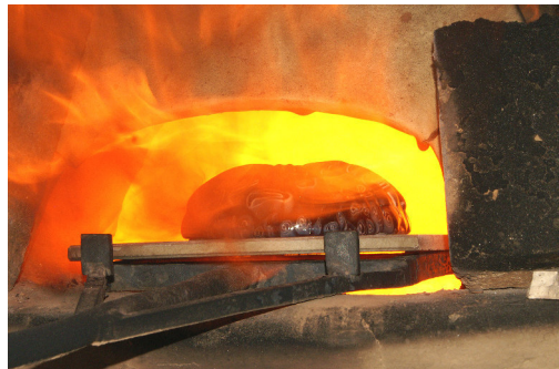
Abb. 10: Immer wieder im Ofen nachheizen. – Repeated reheating inside the glass furnace.
