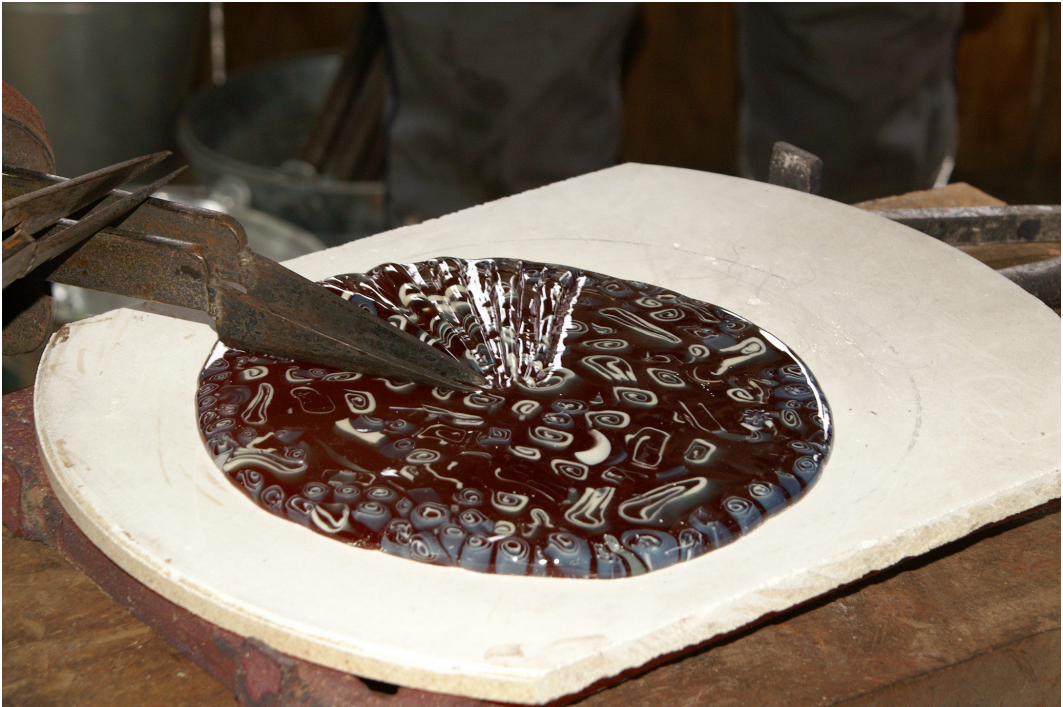
Abb. 7: Einkneifen der Rippen in den heißen Glasfaden. – Pinching the ribs into the hot glass disk.
