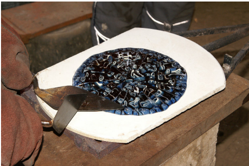
Abb. 8: Absetzen/Abflachen des Randes. – Flattening the rim area.
