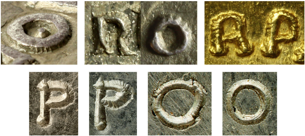
Fig. 10: Chisel marks on letters. Top from left to right: a) Tetradrachm; b) Denarius; c) Solidus. Bottom from left to right: Experimental letters, d) Carefully chiseled P; e) Coarsely chiseled P; f) Coarsely chiseled O made in one turn. Ps and O showing steps, even in straight lines; g) O made with graver. Just a little scratching on the outside edge. – Meißelspuren bei Buchstaben. Oben, von links nach rechts: a) Tetradrachme; b) Denar; c) Solidus. Unten, von links nach rechts: Experimentell gravierte Buchstaben, d) Sorgfältig gemeißeltes P; e) Grob gemeißeltes P; f) Grob gemeißeltes O. Ps und O zeigen Stufen; g) Mit Stichel graviertes O. Man sieht nur leichte Kratzer an der Außenkante.
