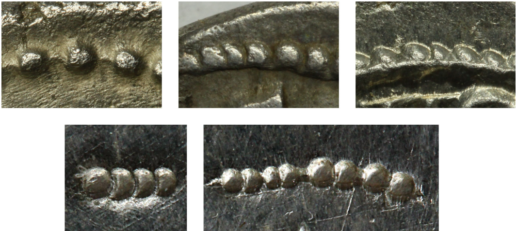
Fig. 9: Beaded borders from Roman coins. Top from left to right: a) Denarius, 47/46 BC. Beads too far apart to interfere; b) Denarius, ca. 150; c) Denarius, 223. Bottom from left to right: Experimental beaded lines, d) Beads showing extreme D-effect because of missing precut line; e) Some D-effect with precut lines. – Perlränder römischer Münzen. Oben, von links nach rechts: a) Denar, 47/46 v. Chr. Ohne Beeinflussung wegen zu großem Abstand; b) Denar, ca. 150; c) Denar, 223. Unten, von links nach rechts: Experimentelle Perllinien, d) Mit extremen Verformungen, da keine Linie vorab graviert wurde; e) Geringer D-Effekt mit einer vorgravierten Linie.
