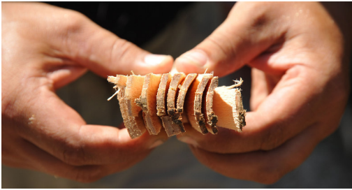
Fig. 9: By pounding pieces of ash wood repeatedly on a hard surface, the individual growth rings can be separated from each other. This flexible and robust material serves as raw material for splint boxes. – Werden Eschenscheite auf einer harten Unterlage geklopft, lösen sich die Jahrringe voneinander und bilden so ein extrem flexibles und hartes Ausgangsmaterial für die Herstellung von Spanschachteln.
