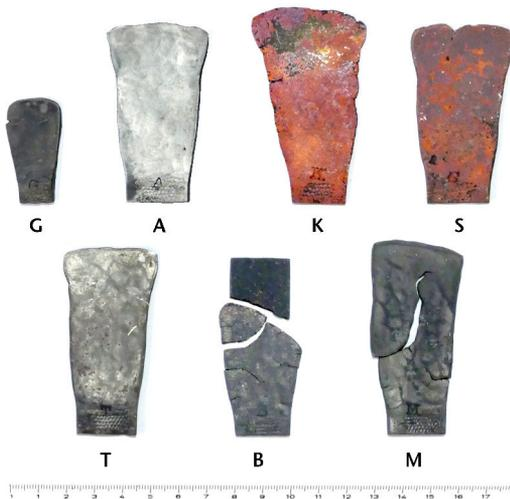
Abb. 5: Die sieben experimentell rekonstruierten Kupferlegierungen von Abbildung 4 nach den Schmiede-, Härtings- und Rekristallisierungsversuchen. Verkleinert (Plättchenbreite ursprünglich 20 mm). – The seven experimentally reconstructed copper alloys in fig. 4 after forging-, annealing- and recrystallization trials. Reduced (original flat blank width 20 mm).
