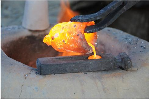
Abb. 10: Gießen eines Rohlings für die Münzprägung. – Casting a blank for coinage.
