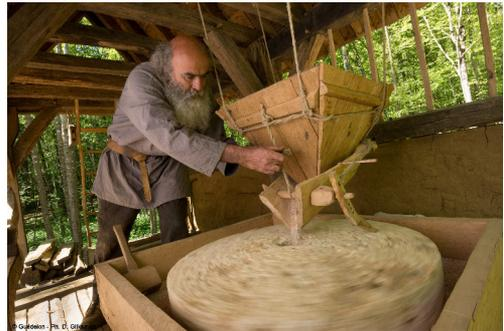
Abb. 8: Rekonstruierte mit Wasser betriebene Getreidemühle des 12. Jahrhunderts. – Reconstructed 12<sup>th</sup> century water-powered grain mill.
