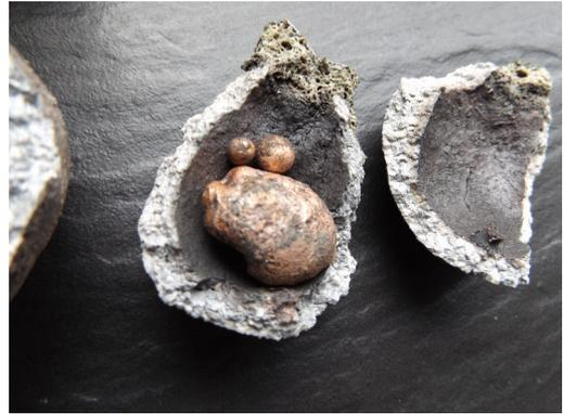
Abb. 4: Ergebnis: Kupfernugget in zerbrochenem Reaktionsbehälter. – Result: copper nuggets in broken receptacle.
