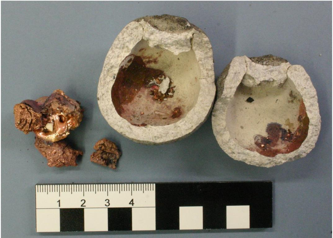
Abb. 6: Ergebnis: Kupferaggregate mit teilweise geschmolzenen Bereichen; Prills im Reaktionsbehälter. – Result: copper aggregates with partly molten sections; copper prills in receptacle.
