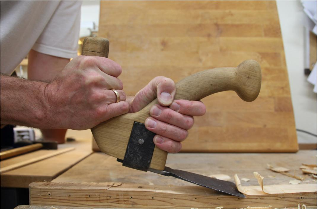
Abb. 10: Die Zweiarmdechsel im Einsatz zum Bestoßen. – The two-handed adze being used for shaving.
