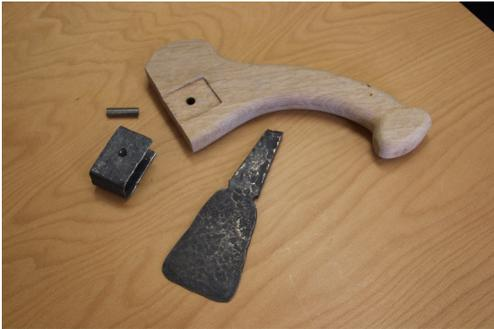
Abb. 9: Die Einzelteile der einarmigen Dechsel vor der Montage. – Components of the single-handed adze before mounting.
