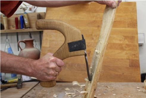
Abb. 8: Die Zweiarmedechsel im Einsatz zum Behauen. – The two-handed adze being used for chopping.
