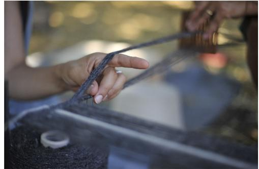
Abb. 4: Die Kettfäden werden in die Anfangskante eingewoben. – The warp threads are woven into the starting border.
