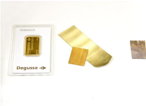
Abb. 4: Rezept 13: Ergebnis: Feingoldbarren, das behandelte goldene Versuchsblech aus 580-iger Gold auf einem unbehandelten Blech aus 580-iger Gold, das Versuchsblech aus Feinsilber. – Recipe 13: result: bullion, the treated gold sample next to a sheet of untreated 580 gold, the “pinkish” silver sample. The recipes intent is the intensification of gold colour in order to make it look like pure gold.
