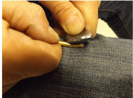
Abb. 5: Rezept 4: Anpolieren des mit Goldblech ummantelten Silberrundstabes. – Recipe 4: polishing the gold-coated silver wire.
