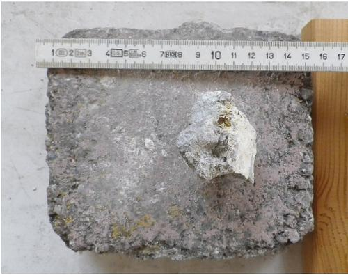
Abb. 8: Geröstetes Galmei-Erz vor der Zerkleinerung. – Roasted calamine ore before crushing.
