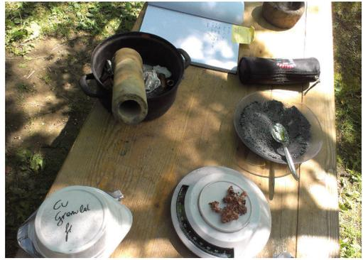
Abb. 3: Versuch 1, links die Rohrbombe, rechts der Zement, unten auf der Waage das rotstichige Kupfergranulat. – Experiment 1, left side the pipe bomb, right side the cement, on the bottom the copper on a scale.
