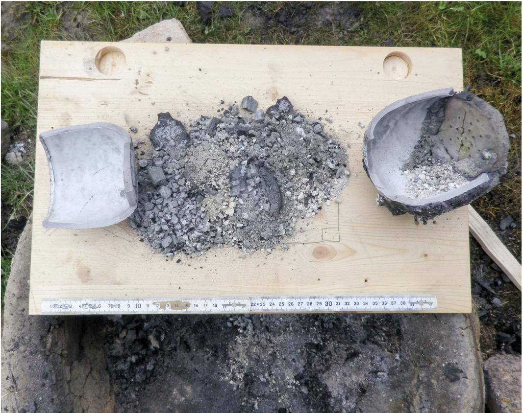
Abb. 10: Überreste des Zementes aus Versuch 3. – Residues of the cement from experiment 3.
