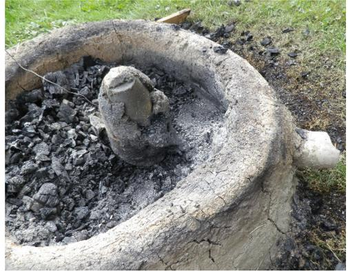
Abb. 4: Das Reaktionsgefäß aus Versuch 2, starke Verglasung an der Front des Gefäßes. – The cooled down reaction vessel from experiment 2 after firing process, the front of the vessel is strongly glazed.
