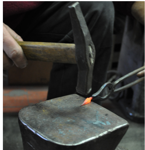
Abb. 7: Ausschmieden der Zinkenspitzen auf dem Schildamboss. – Cutting out the crampon prong tips on the shield-shaped anvil.
