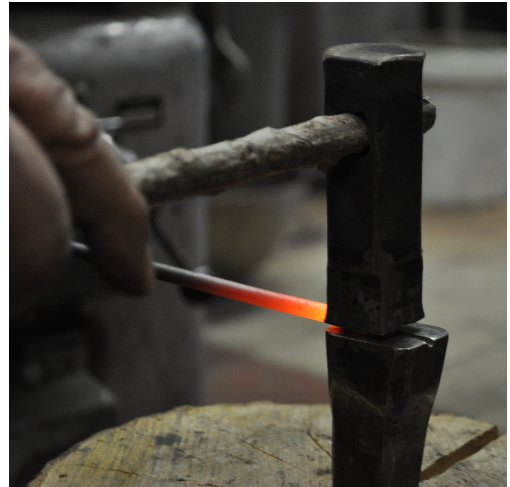
Abb. 6: Strecken und Ausformen des Nietschaftees mit dem Setzhammer auf dem kleinen Amboss mit Sicke. – Stretching and beating out of the rivet shaft with a set hammer on a small anvil with a crease (crimp).
