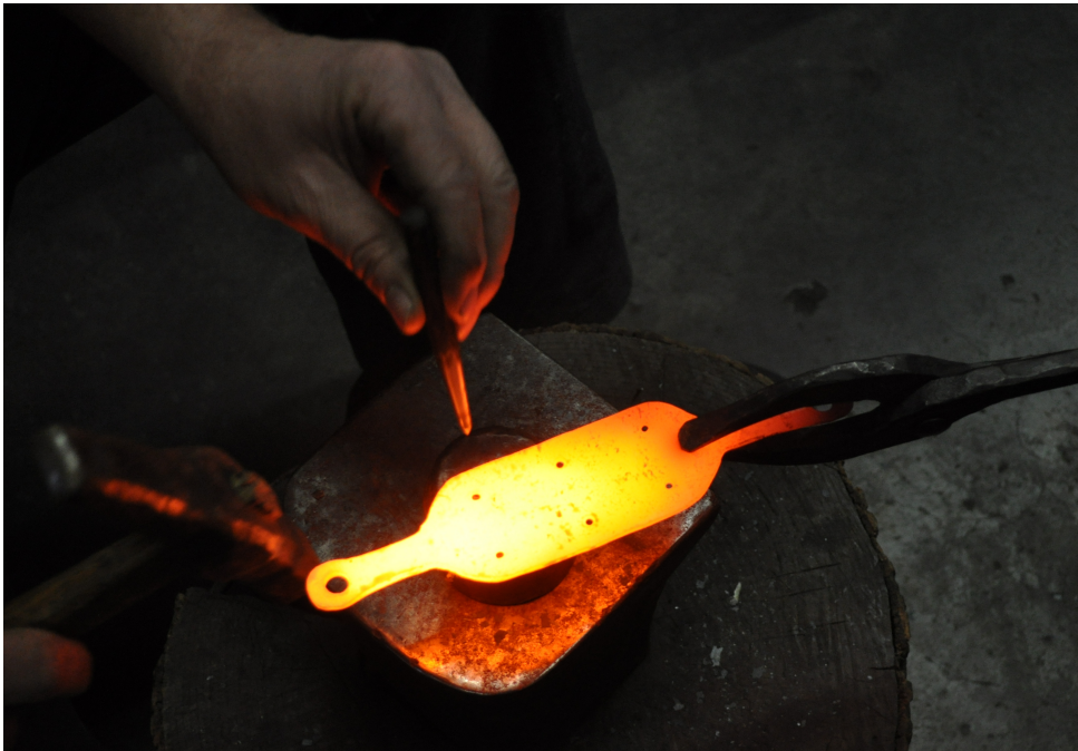
Abb. 5: Lochen der Nietlöcher mit dem Durchschlag auf eine lichte Weite von 4 mm. – Rivet hole perforation with a clear-span punch of 4 mm.
