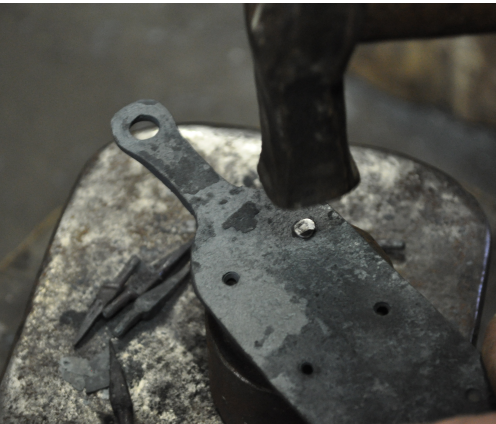
Abb. 9: Vernieten: Ausformen des Schließkopfes an der Innenseite der Grundplatte. – Riveting: forming the snap head on the inner side of the base plate.
