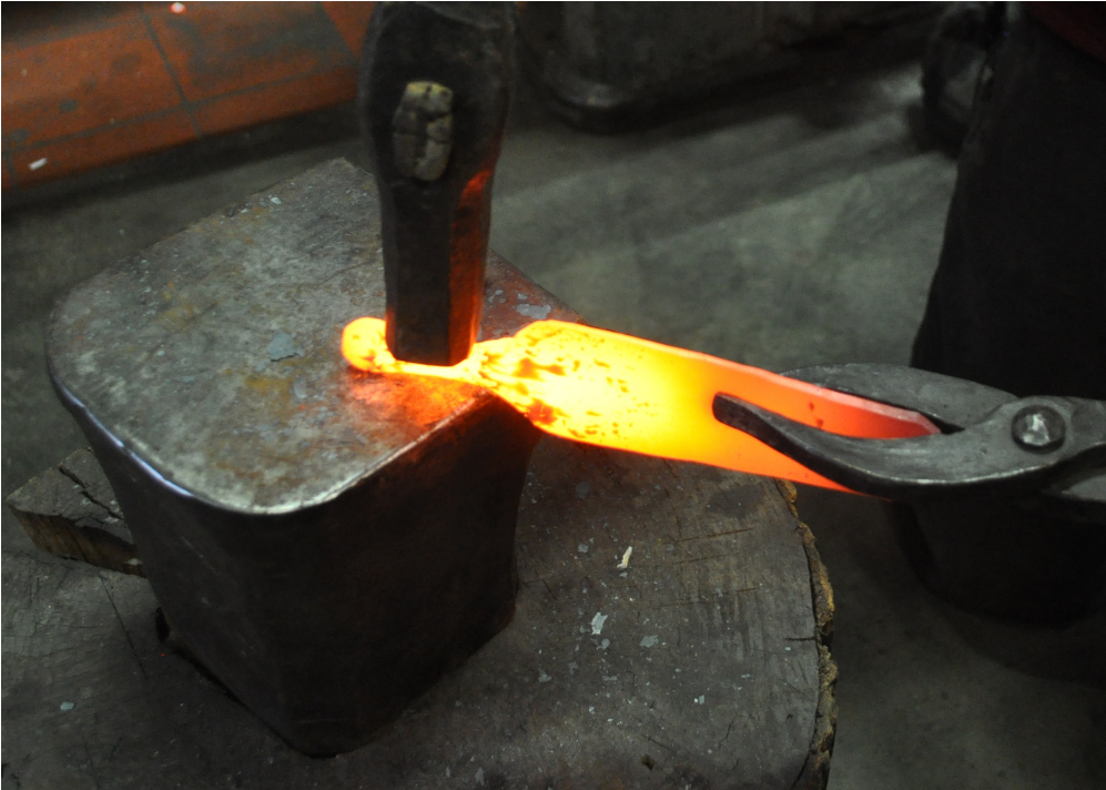
Abb. 4: Absetzen der „Steigeisenenden“ auf dem Schildamboss. – Placing the “crampons tips” on the shield-shaped anvil.
