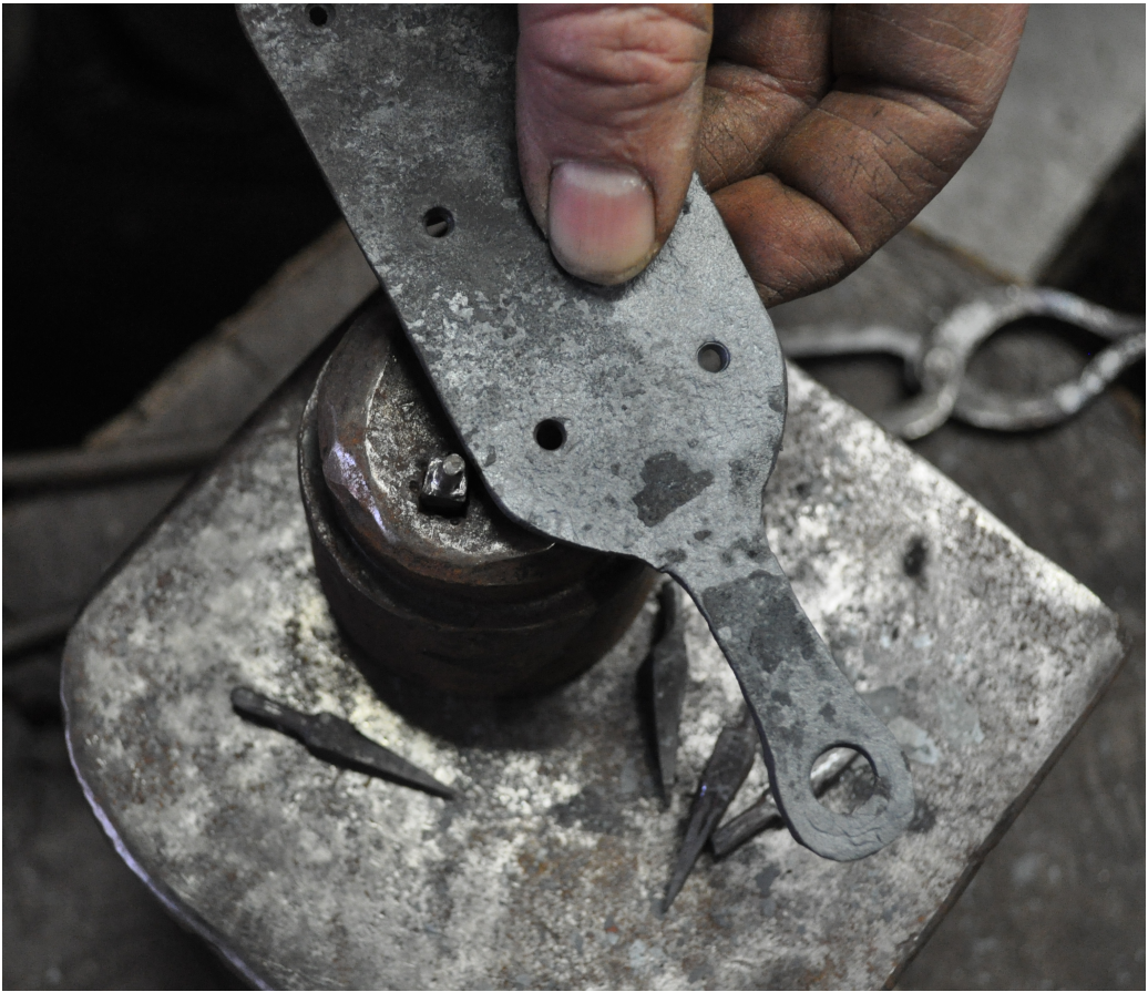
Abb. 8: Zinkenspitze im Gesenk mit Blick auf den Nietschaft. – Prong tips in the swage with a view on the rivet shaft.
