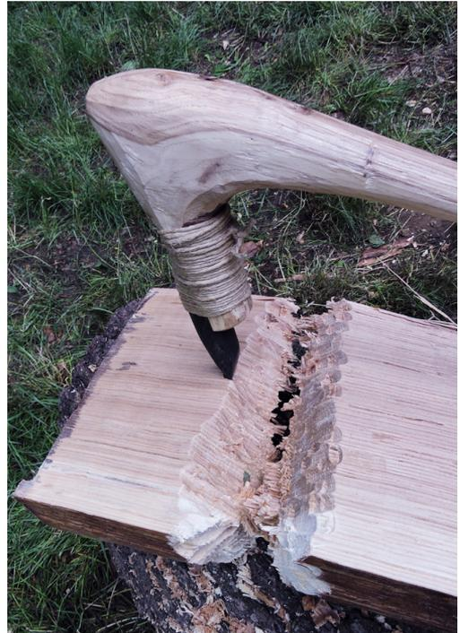
*Abb. 5: Eine schmalhohe Dechselklinge wurde zum Abtrennen der Spaltbohlen eingesetzt. – A so-called slimhigh adze blade was used to cut off the split boards.*
