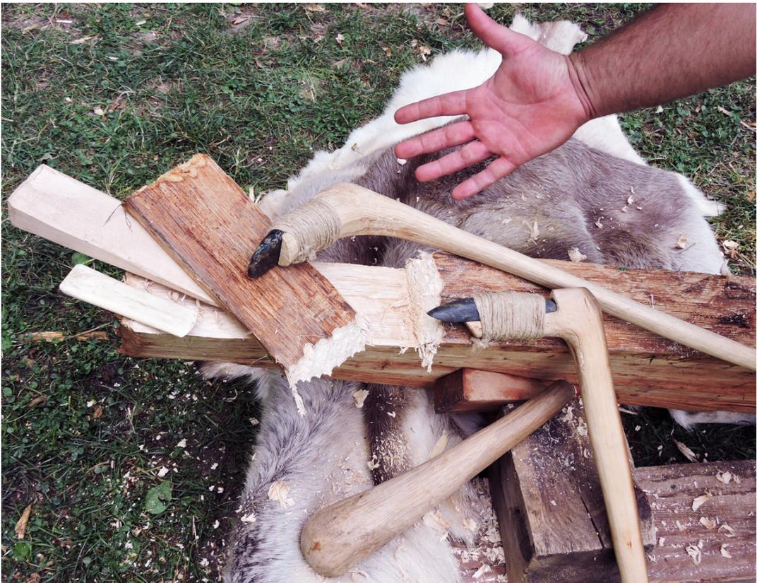
Abb. 7: Das Splintholz konnte auch mit Holzkeilen entfernt werden; im Bild: Knochenbeitel, Holzkeil, flachbreite und schmalhohe Dechselklingen auf offenen Knieholzschäften, Klopffholz. – The sap wood could also be removed with wooden wedges; in the picture: bone chisel, wooden wedge, broadflat and slimhigh adze blades fixed to blunt-angled knee shafts, wooden mallet.
