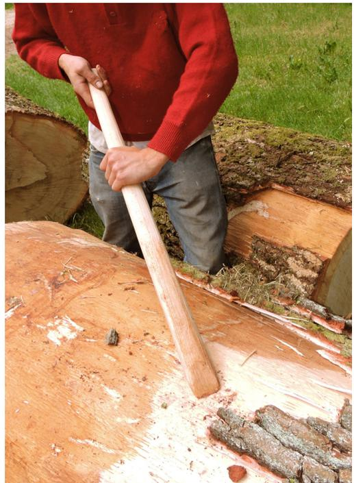
Abb. 3: Mit einem Stoßwerkzeug aus Holz ließ sich die Eichenrinde gut entfernen. – A special wooden pushing tool was useful for debarking the oak trunks.
