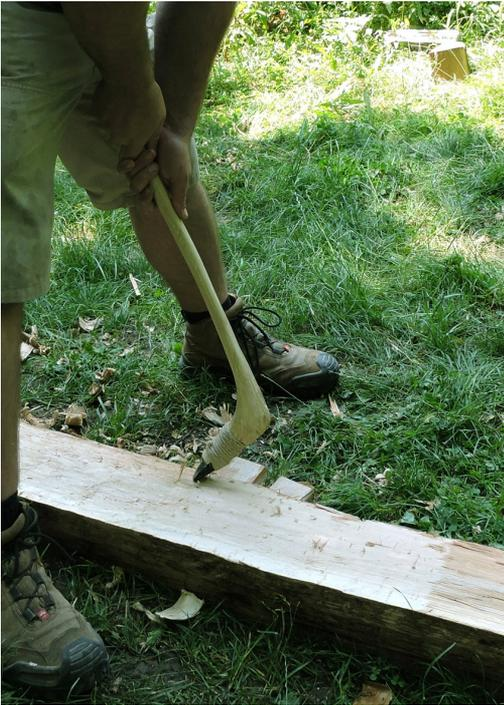
*Abb. 8: Die Oberfläche eines Spaltholzes wird mit einer flachbreiten Dechselklinge auf einer Knieholzschäftung mit einem Winkel von 109° geglättet. – The surface of a split board is smoothed down with a broadflat adze blade fixed to a knee shafts with an angle of 109°.*
