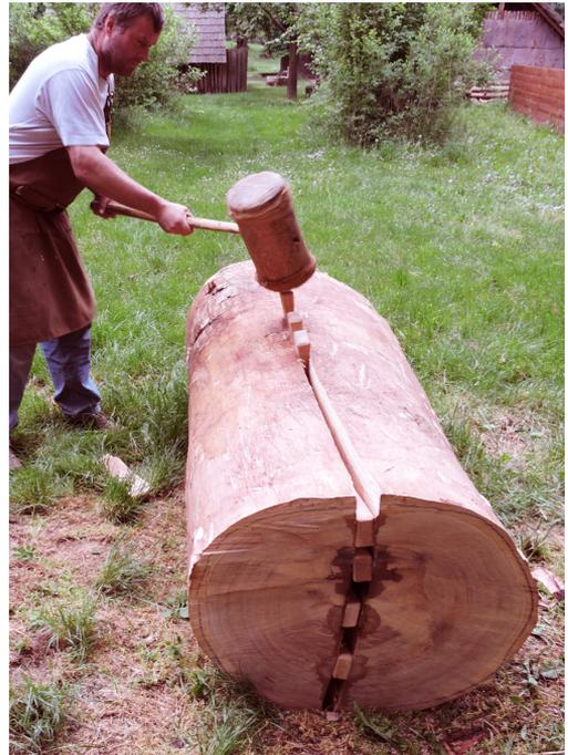
*Abb. 4: Erst nachdem wir mit mehreren Keilen am Stirnholz der Stammtrommeln die Rissrichtung vorgegeben hatten, wurden Keile an den Breitseiten eingeschlagen. – Several wedges driven into the trunks' end grain face enabled us to start initial cracks and determine their direction; then we hammered some more wedges into the trunks' outside in order to split them.*
