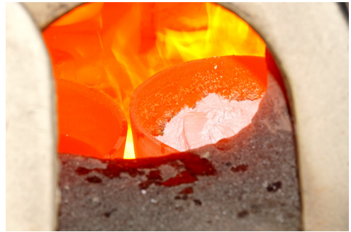
Abb. 8: Gerade zum Schmelzen in den rechten Glashafen eingefüllter frischer Glasansatz „Borger Mischung“. – Fresh glass batch „Borger Mischung“ just being filled into the right hand glass pot for melting.
