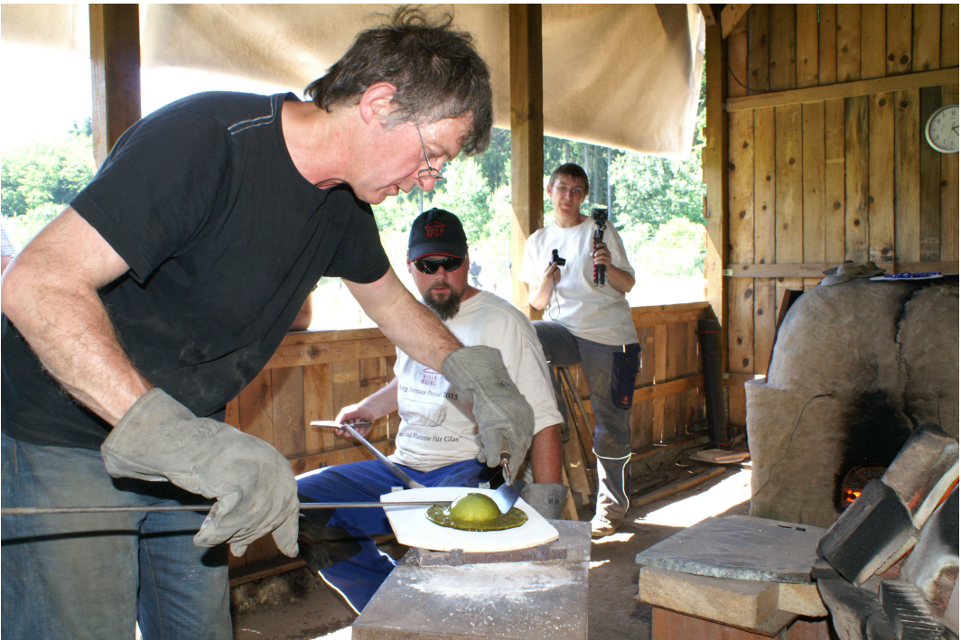
Abb. 12: Mark Taylor formt ein kuppelförmiges Fensterglas. – Mark Taylor shaping a domed window glass.
