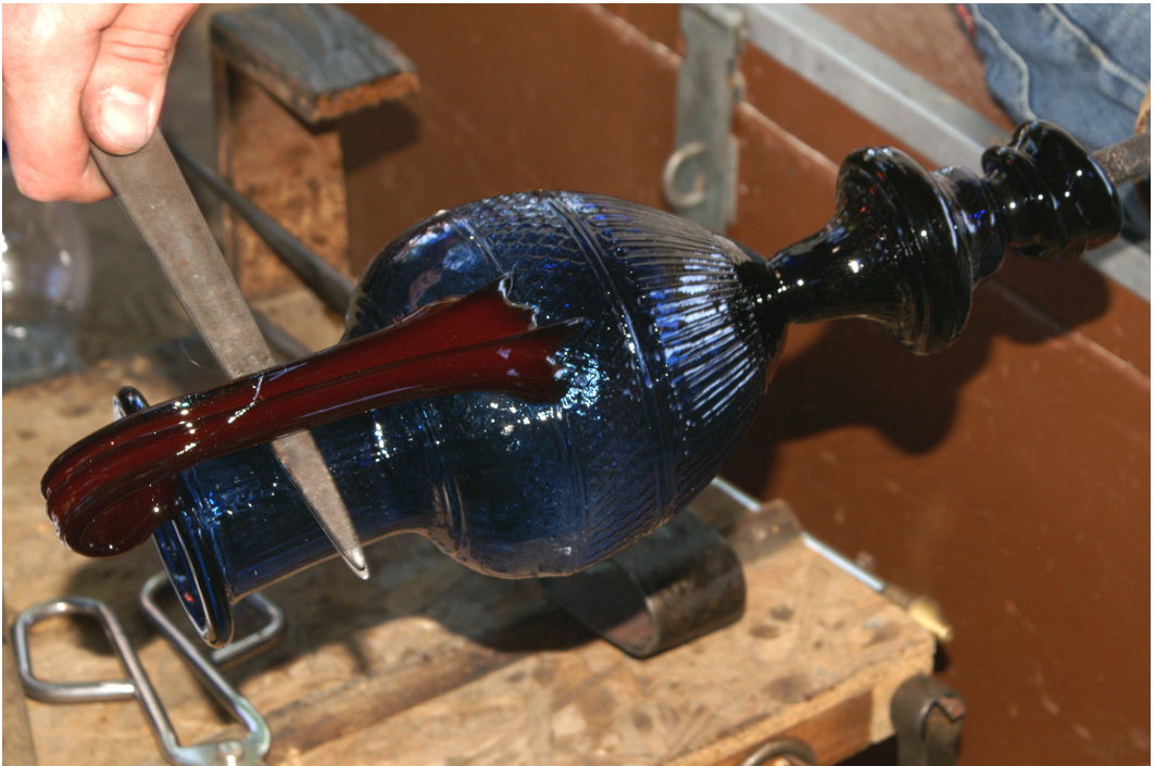
Abb. 3: Formen des Henkels eines ENNION-Kruges. – Forming the handle of an ENNION jug.
