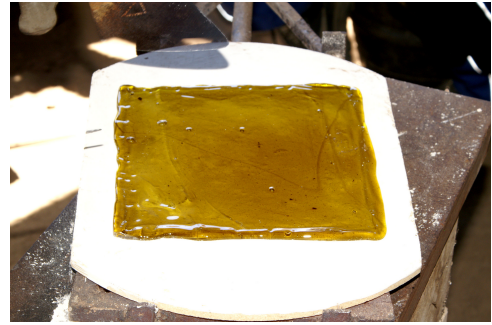
Abb. 11: Rekonstruiertes Flachglas (Fensterglas) römischer Machart. – A reconstructed flat window pane made in Roman tradition.
