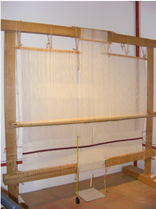
Abb. 4: Fast die Hälfte der Kindertunika ist gewebt. In der Mitte ist der eingewebte Halsausschnitt sichtbar. – Nearly half of the children's tunic is woven. In the middle the slit forming the neck-opening is visible.
