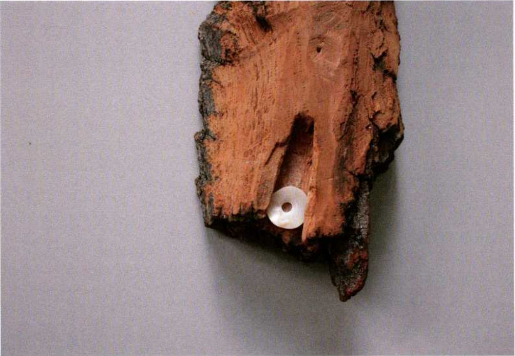
Abb. 7: Rundgeschliffener Paillettenrohling in Klemmvorrichtung (Vorbild Rudolf Wendling, Wiehe). – Rounded polished shell sequin blank in a clamping device (model Rudolf Wendling, Wiehe).
