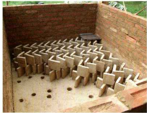
Abb. 8: Einsetzen der Ziegelrohlinge in den Ofen. – Placing the green bricks in the kiln.
