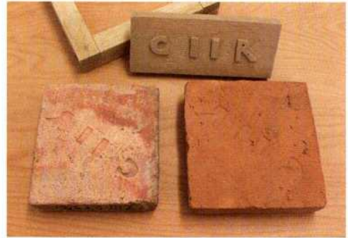
Abb. 7: Der römische Ziegel, die Nachbildung und der Ziegelstempel mit Streichrahmen. – The Roman brick, the replica and the brick stamp with brick mould.
