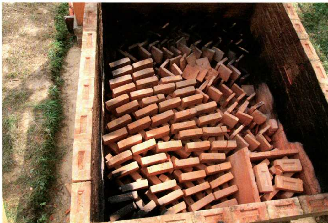
Abb. 10: Der Ziegelofen nach dem Brand. – The brick kiln after firing.
