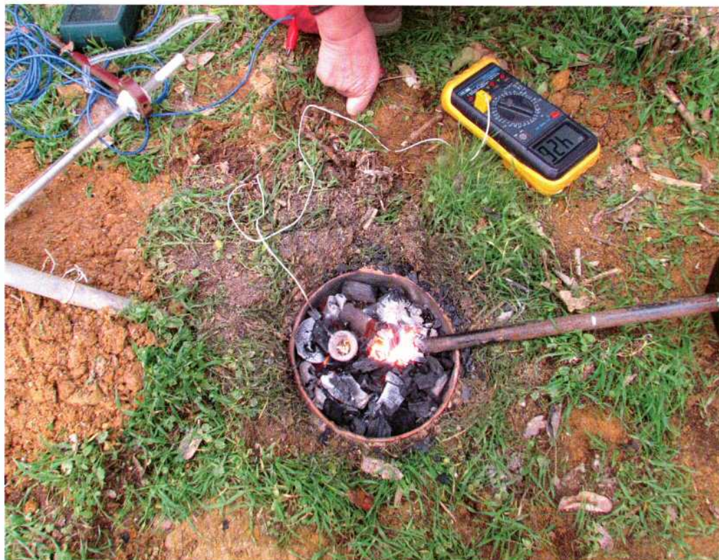
Fig. 3: First stage of the experiment. Melting of silver-gold alloy "Doré". – Erster Abschnitt des Experiments. Schmelzen der Silber-Gold-Legierung „Doré“.
