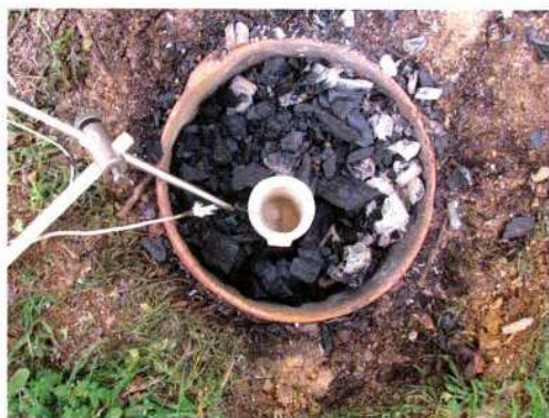
Fig. 5: Melting a gold concentrate extracted from the Ada Tepe ore. – Schmelzen eines Goldkonzentrates extrahiert aus dem Ada Tepe Gold.
