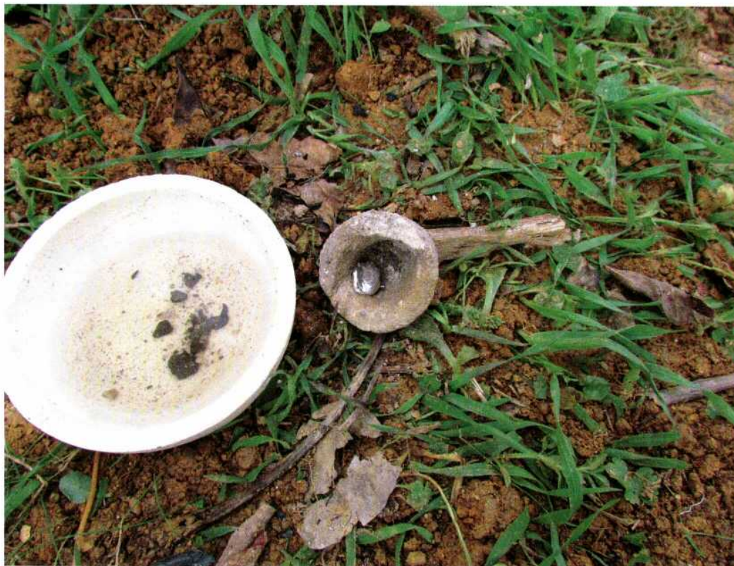
Fig. 4: Melt of silver-gold alloy "Doré". – Schmelzen der Silber-Gold-Legierung "Doré".
