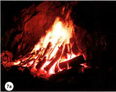
Abb. 7: Prozess langfristiger Erhitzung des goldhaltigen Quarzgangs: a. Unterhalten des Feuers in der Nacht; b. Endsituation nach dem Abbrechen der Erhitzung. – Heating the gold-bearing quartz vein: a. Maintaining the fire through the night; b. The final situation after discontinuing the heating.
