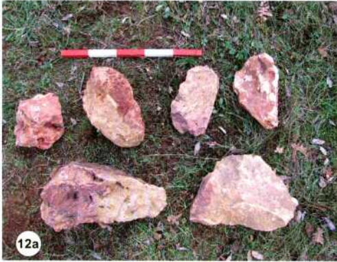
Abb. 12: Korrelation von Gesteinsproben mit Feuersetzungsspuren: a. Originalmuster mit spätbronzezeitlichem Bergbaukontext, Gipfel und hohe Osthänge von Ada Tepe; b. Neue Muster, erzeugt durch das Experiment. – Comparison of rock specimens with traces of fire: a. Ancient specimens from the summit and the high eastern slopes of Ada Tepe, mined in the Late Bronze Age; b. Specimens from the experiment.
