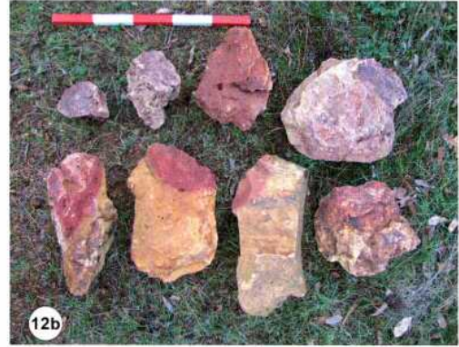
Abb. 12: Korrelation von Gesteinsproben mit Feuersetzungsspuren: a. Originalmuster mit spätbronzezeitlichem Bergbaukontext, Gipfel und hohe Osthänge von Ada Tepe; b. Neue Muster, erzeugt durch das Experiment. – Comparison of rock specimens with traces of fire: a. Ancient specimens from the summit and the high eastern slopes of Ada Tepe, mined in the Late Bronze Age; b. Specimens from the experiment.
