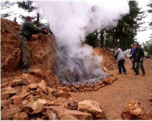
Abb. 9: Schockabkühlung des erhitzten Felsens mit Wasser. – Shock cooling of the heated rock with water.
