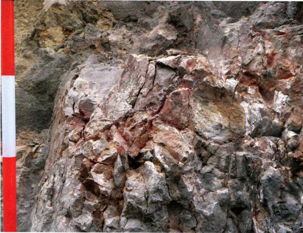
Abb. 8: Der nach der Feuersetzung rissig gewordene Felsen. Rechts ist der Quarzgang leicht erkennbar. – Cracked rock after applying the fire method. The quartz vein is clearly seen to the right.
