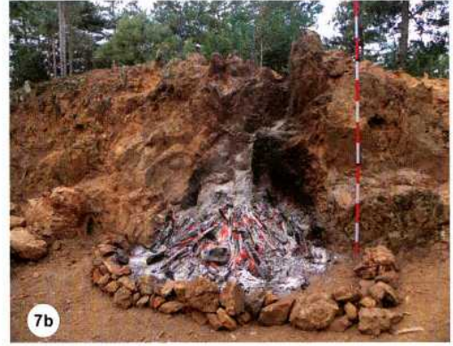
Abb. 7: Prozess langfristiger Erhitzung des goldhaltigen Quarzgangs: a. Unterhalten des Feuers in der Nacht; b. Endsituation nach dem Abbrechen der Erhitzung. – Heating the gold-bearing quartz vein: a. Maintaining the fire through the night; b. The final situation after discontinuing the heating.
