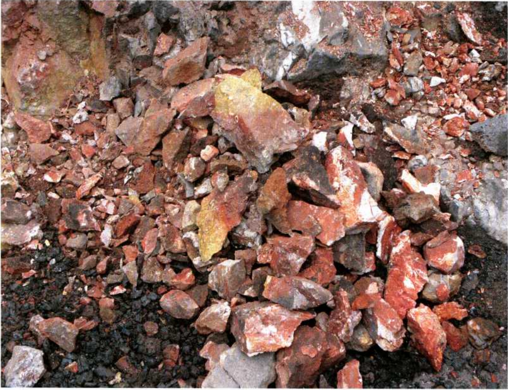
Abb. 10: Aussortiertes reiches Erzmaterial, das aus dem mit der Feuersetzungsmethode bearbeiteten Bereich abgebaut wurde. – Sorted rich ore material, extracted from the site, treated with fire.
