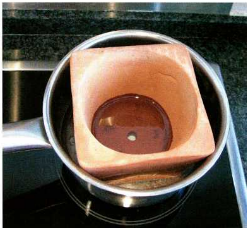
Abb. 1: Vorbereitung einer Referenzprobe für den Nachweis von absorbierten Fettstoffen in Keramik mit Neutronen-Radiographie. – Preparation of a reference sample for the detection of absorbed fats in pottery with neutron radiography.
