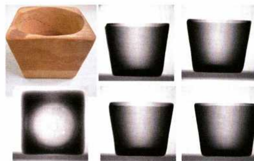
Abb. 2: Foto und Neutronen-Radiographien einer Referenzprobe. – Photograph and neutron radiographs of a reference sample.
