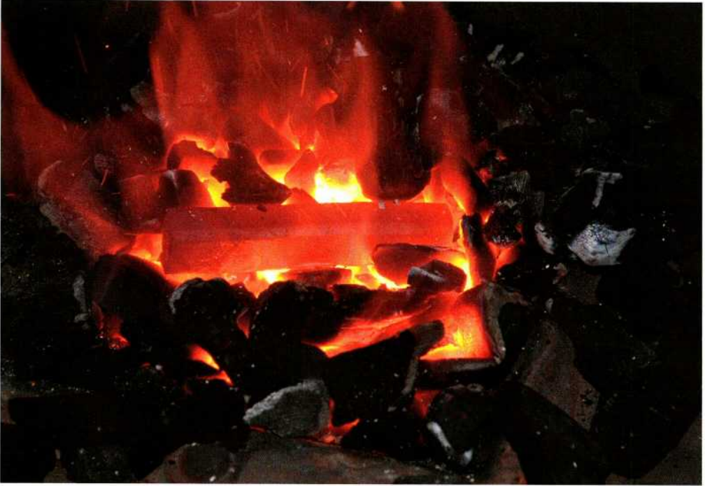
Abb. 5: Abgelängter Bergeisenrohling im Schmiedefeuer (Holzkohle). – Pick (or gad) blank in the smithy fire (charcoal) after cutting to length.
