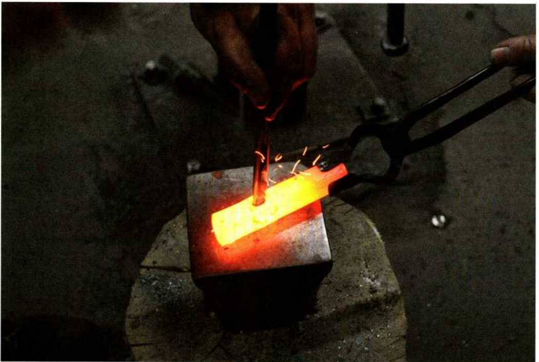
Abb. 6: Aufspalten des Bergeisenrohlings. – Splitting of the pick blank.
