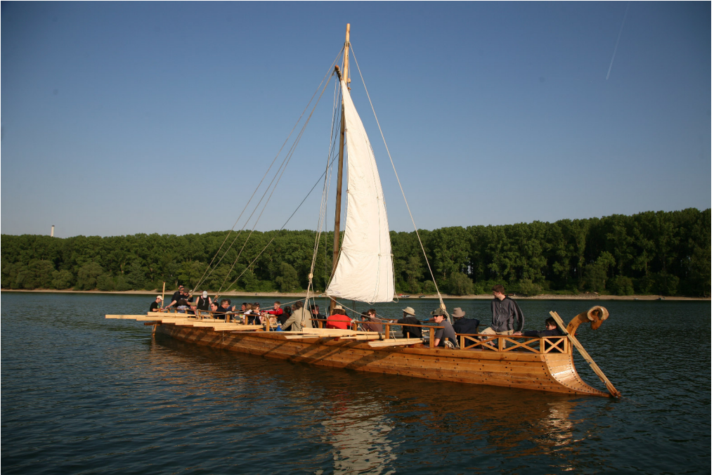
Abb. 7: Seitlich gestelltes Rahsegel bei den Testfahrten der Lusoria Rhenana. – Square sail set through test trials.
