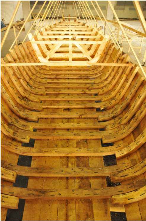
Abb. 4: Mallenkonstruktion: Bauschablonen zur Definition der Rumpfform. – The Mallen: a mold construction defining the hulk.
