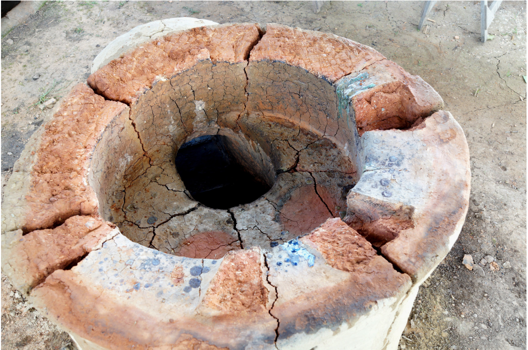
Abb. 6: Risse der Ofenbasis vom Glas-Schmelzofen „GO-Borg 1“ nach Abnahme der Ofenkuppel (18.04.2014). – Cracks in “GO-Borg 1”'s furnace base after dismantling the dome (18.04.2014).
