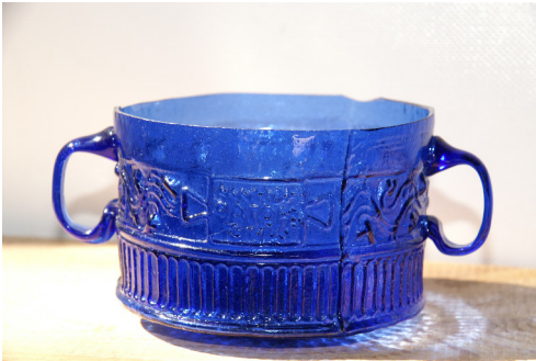
Abb. 10: Der ENNION-Becher nach Abtrennen der Oberkappe. Der Rand kann noch schleifend bearbeitet werden. – The ENNION beaker after cracking off the top. The rim may be ground.
