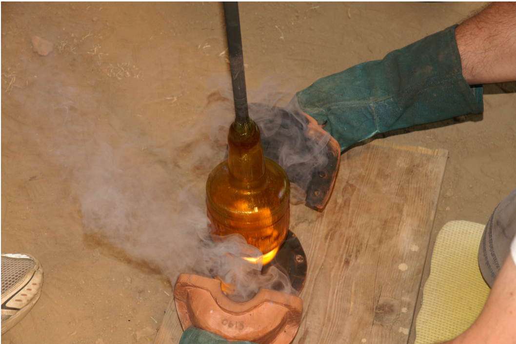
Abb. 9: Einblasen in die Tonform eines ENNION-Bechers beim BFP2014. – Blowing a ENNION beaker in a ceramic mould at the BFP2014.
