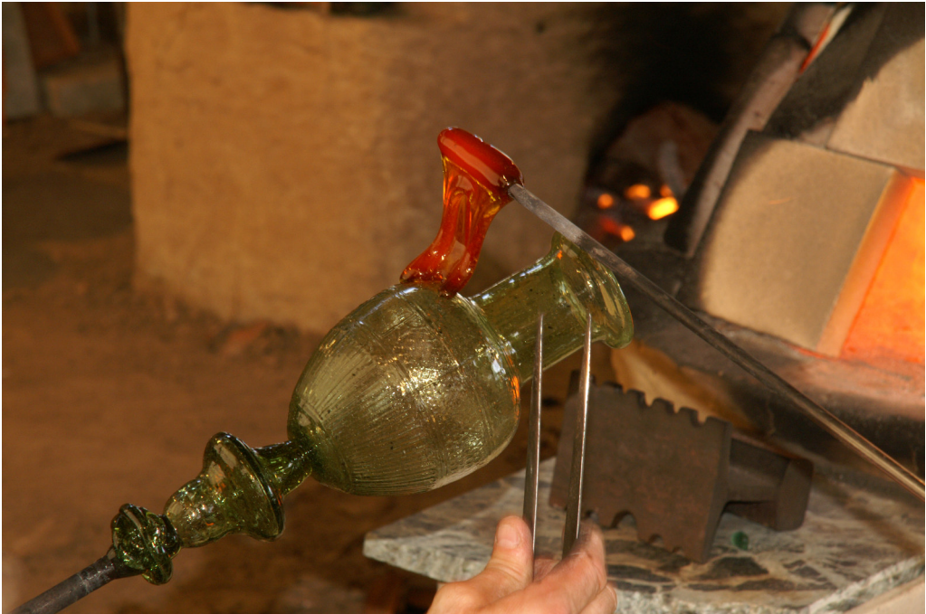
Abb. 7: Ansetzen des Henkels am ENNION-Krug beim BFP2014. – Attaching the handle to the ENNION jug at the BFP2014.
