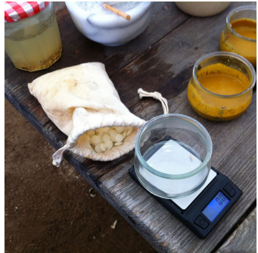
Abb. 2: Abwiegen der Zutaten Wachs, gelöstes Harz und Leinöl, rechts: Testmischungen. – Measuring beeswax, linseed oil and liquid resin, test samples on the right-hand side.
