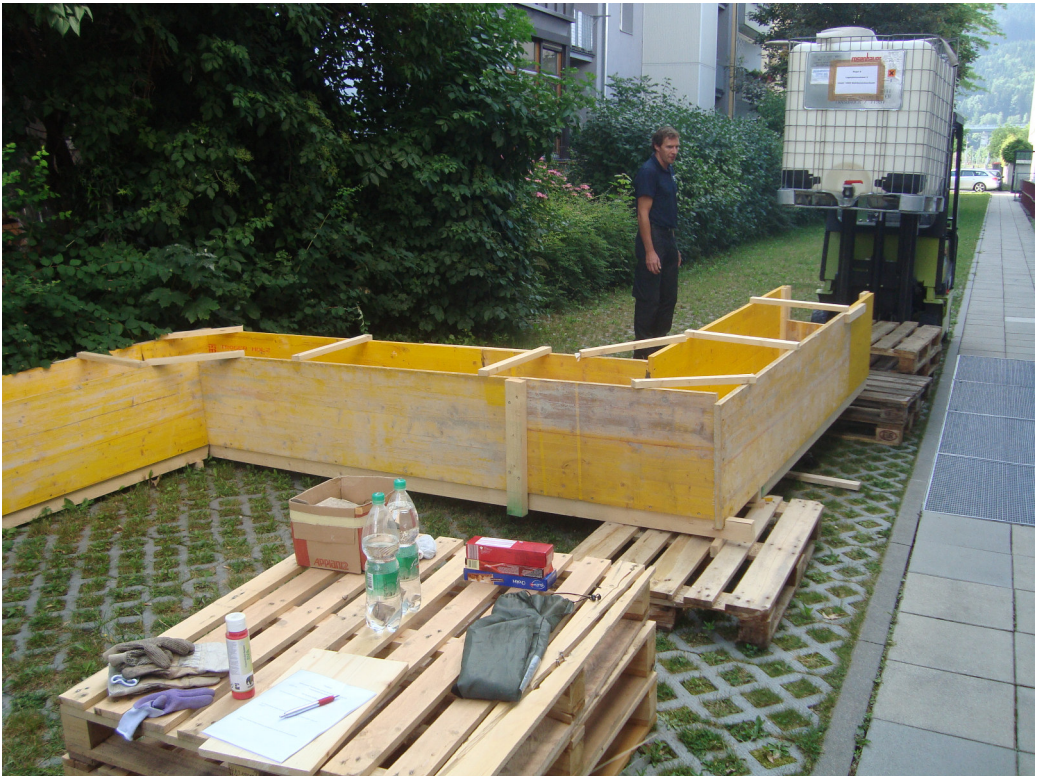
Abb. 3: Versuchsanordnung am 26.6.2014: nachgebauter Latrinenkanal und Gabelstapler mit Wasserbehälter zur Wasserversorgung und Druckregulierung. – Experimental arrangement on 26.6.2014: reverse engineered latrine canal and fork lift truck with water container for water supply and pressure regulation.
