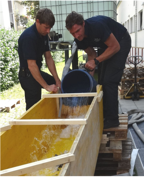
Abb. 10: „Aktive Schwallspülung“ mit 60 l Wasser. – “Active Surge Flushing” with 60 l of water.
