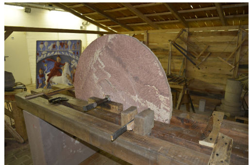
Abb. 4: Der Rohling einer Tischplatte aus Sandstein auf der Steindrehbank. Das Besondere ist hierbei, dass die beiden Lager auf der Werkzeugführung fixiert werden. – A sandstone tabletop blank on the stone lathe. In this case, both bearings are fixed on the tool guides.
