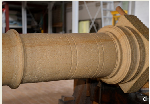
Abb. 3: a) Der Rohling einer Tischsäule auf der rekonstruierten Steindrehbank; b) Um den Rohling symmetrisch abzarbeiten, werden umlaufende Rillen in den Schaft eingeschliffen. Die Zwischenräume werden von Hand abgearbeitet; c) Mit dem waagrecht fixierten Flachmeißel wird die Oberfläche glattgeschliffen; d) Die fertiggestellte Tischsäule mit ihrer charakteristischen Profilierung. – a) The table column blank on the reconstructed stone lathe; b) To cut the piece symmetrically, circulating grooves are ground into the column; The intermediate spaces are worked manually; c) The surface is smoothed by using the horizontally-fixed flat chisel; d) The final table column with the characteristic profiling.
