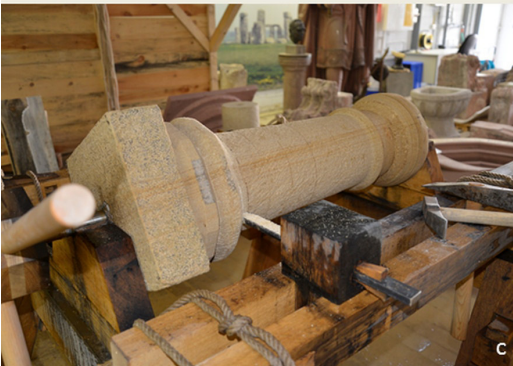
Abb. 3: a) Der Rohling einer Tischsäule auf der rekonstruierten Steindrehbank; b) Um den Rohling symmetrisch abzarbeiten, werden umlaufende Rillen in den Schaft eingeschliffen. Die Zwischenräume werden von Hand abgearbeitet; c) Mit dem waagrecht fixierten Flachmeißel wird die Oberfläche glattgeschliffen; d) Die fertiggestellte Tischsäule mit ihrer charakteristischen Profilierung. – a) The table column blank on the reconstructed stone lathe; b) To cut the piece symmetrically, circulating grooves are ground into the column; The intermediate spaces are worked manually; c) The surface is smoothed by using the horizontally-fixed flat chisel; d) The final table column with the characteristic profiling.
