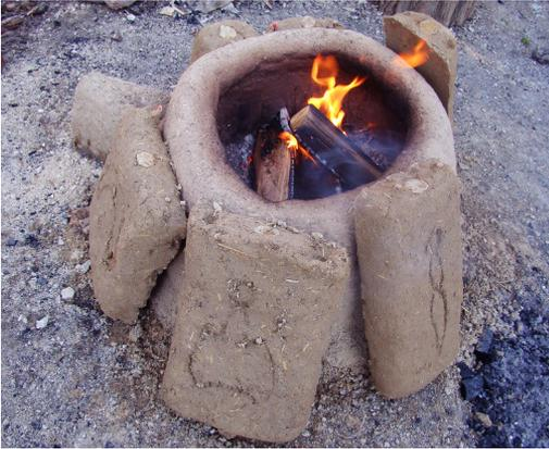
*Abb. 5: Die gut getrockneten Lehmformen werden am Ofen behutsam erhitzt, um das Wachs ausschmelzen zu können. – The well dried clay moulds are carefully heated beside the oven to melt out the wax.*
