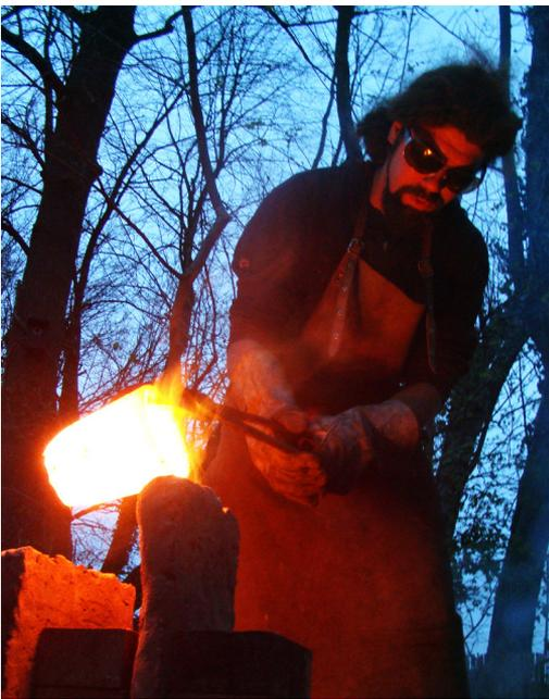
*Abb. 6: Die heiße Bronze wurde in vorgeheizte Lehmformen gegossen. – Casting the hot bronze into the preheated moulds.*
