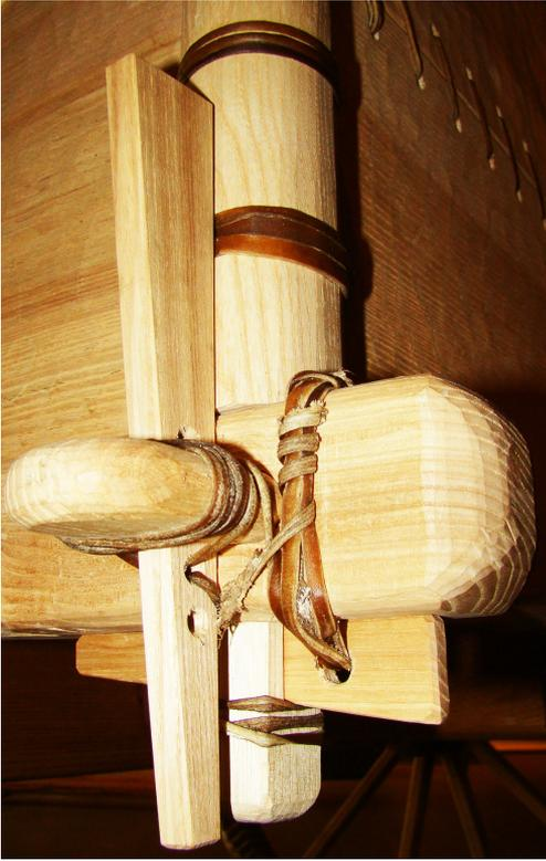
*Abb. 11: Die Durchsteckzapfen des Wagenkastens wurden durch Zapfenschlösser mit Keilen, aber auch durch Rohhautbindungen gesichert. – The through-tenons of the chariot frame were fixed with key-wedges, as well as raw-hide bindings.*
