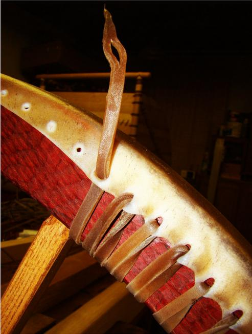
*Abb. 7: Die Rohhautauflagen der Wagenräder wurden seitlich gelocht, in Wasser eingeweicht und mit dünnen Rohhautstreifen auf die Holzfelgen genäht. – The raw-hide cover of the wheels was sewn on the wooden rims with thin raw hide strips.*
