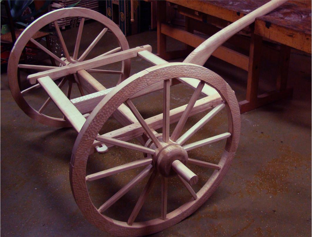
*Abb. 5: Der Unterbau des Streitwagenmodells mit Speichenrädern, Achse, Deichsel und Basisrahmen des Wagenkastens. – The subconstruction of the chariot model with spoked wheels, axis, pole and basis frame of the chariot box.*
