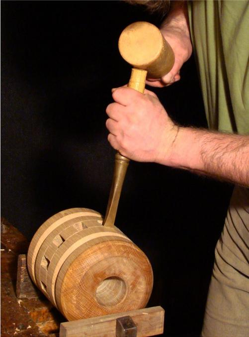
*Abb. 3: Nach dem Vorbohren wurden die Speichenlöcher der Naben mit einem Bronzemeißel rechteckig ausgeformt. – After the drilling of the spoke holes, they were reworked with a bronze chisel to give them their rectangular form.*
