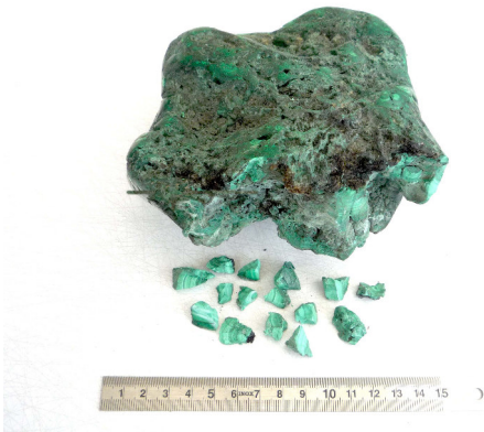
Abb. 1: Malachit-Abschläge, die für die Verhüttung nach der Pellet-Technologie verwendet wurden. – Pieces of malachite prepared for extracting copper using pellet technology.
