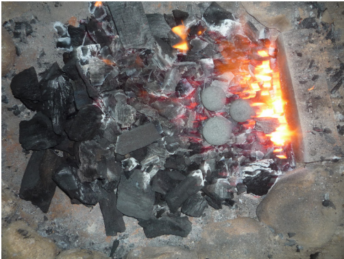
Abb. 2: Pellets in einem Holzkohlefeuer. Die Luftzufuhr erfolgt von der Seite aus, um ein Temperaturgefälle zu erzeugen. – Pellets in a bed of charcoal. The air supply is from one side only to generate a temperature gradient.
