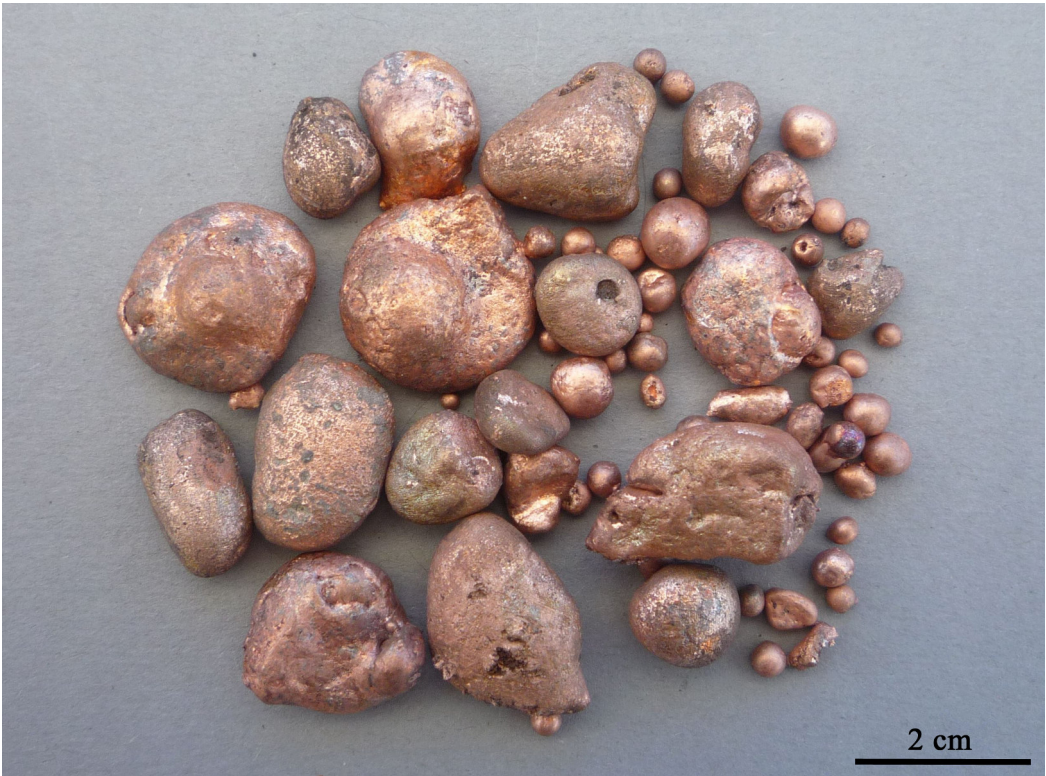
Abb. 8: Schmelzperlen aus Kupfer, die in einem Pellet durch Aufschmelzen von porösen Kupferaggregaten entstanden sind. Einige der größeren Schmelzperlen sind durch Zusammenschmelzen von kleineren Schmelzperlen entstanden. – Beads of ductile copper, generated by re-melting the porous copper from inside the pellets. Some of the large beads are formed by fusion of smaller beads.
