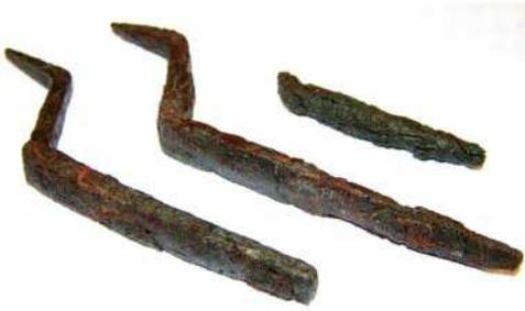
Abb. 3: Gekröpfte Feilen aus Sévaz, Länge 13 und 15 cm. Solche Feilen mit in der Höhe versetztem Griff erlauben das Befeilen ebener Flächen, was mit den heute üblichen Feilen mit geradem Griff nicht möglich ist. – Cranked files from Sévaz, lengths 13 cm and 15 cm. Such files with a moved up handle allow the filing of plane surfaces which isn't possible with today's straight handled files.
