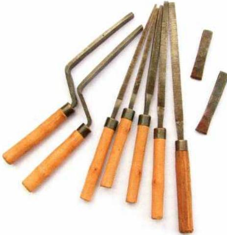
Abb. 5: Einige der Feilen unterschiedlicher Form, die in der rekonstruierten Werkstatt gute Dienste geleistet haben. Mit den zwei kleinen Meißeln rechts im Bild wurden sie gehauen. – Some of the files with different shapes which worked well in the reconstructed workshop. With the two little chisels on the right side of the picture they were set.
